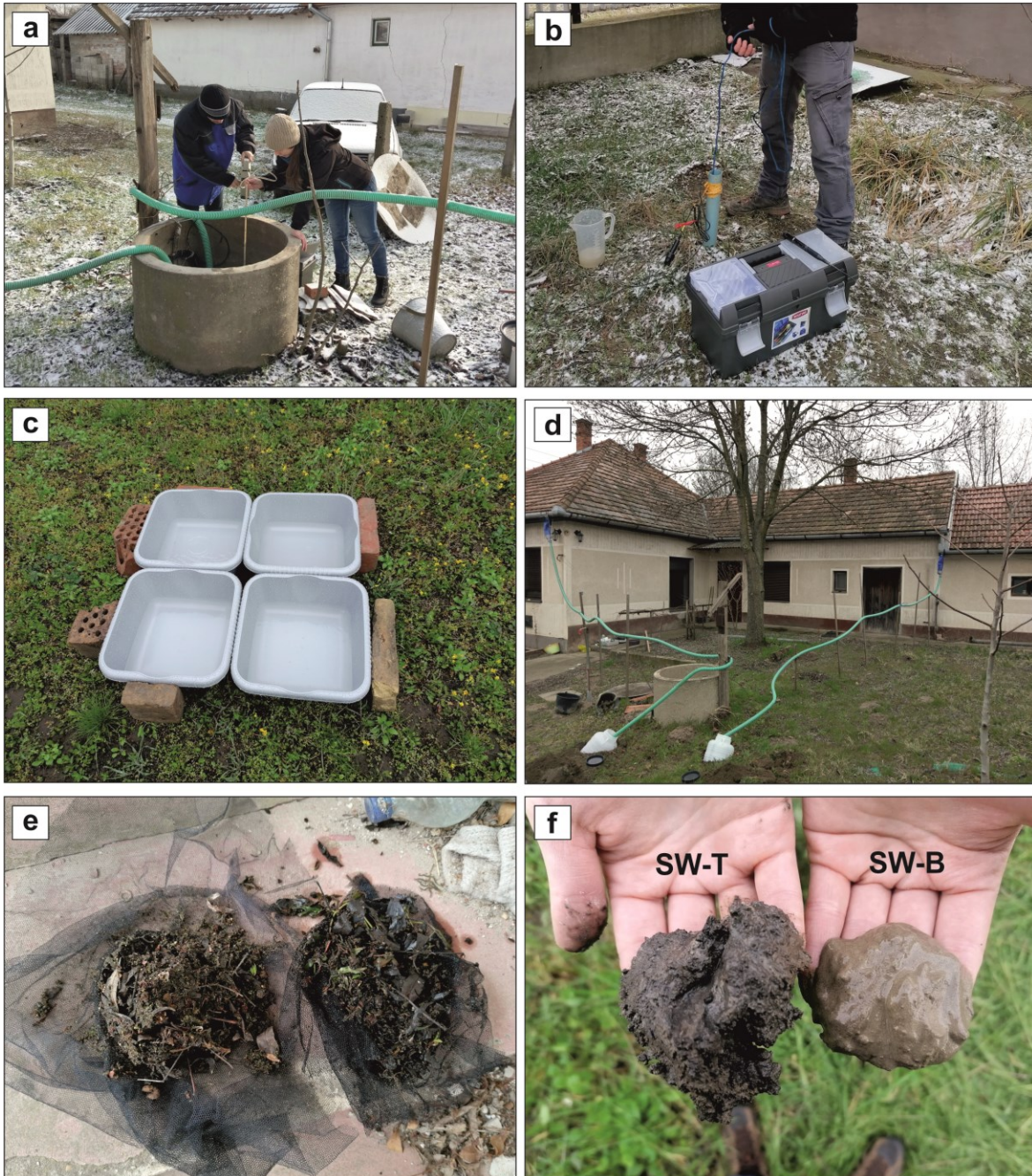
a) Vízszintmérés SW-ben; b) Vízmintavétel P2-ből; c) Esővízgyűjtés mintázáshoz; d) Tetővízgyűjtés mintázáshoz; e) A szűrőben összegyűlt levelek és egyéb szennyeződések; f) A kút talpáról vett minták (felső szint: SW-T, alsó szint: SW-B)
