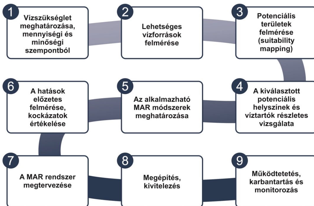
2.4. ábra: A MAR rendszerek megtervezésének lépései ( Salameh és mtsai., 2019 alapján Szabó és mtsai., 2020).
