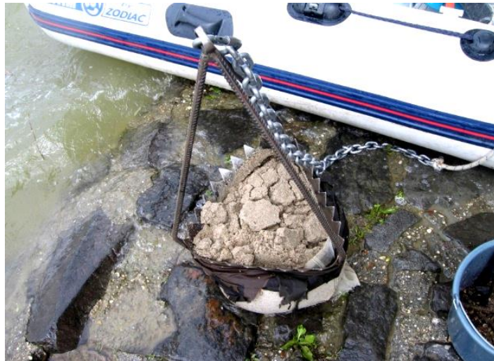
2. ábra: Mélységi mintavevő, amellyel a keresztmetszeti vizsgálatunk mintáit gyűjtöttük
