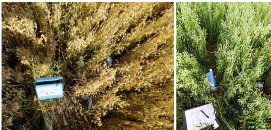
7. ábra: A dinamikus kamrás talaj CO 2 kibocsátás mérés EGM-5 analizátor segítségével a Józsefmajori Kísérleti Tangazdaság talajművelési tartamkísérletében (fotók: Dencső Márton)
