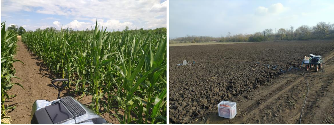
11. ábra: A dinamikus kamrás talaj CO 2 kibocsátás mérés Picarro analizátor segítségével a martonvásári trágyázási tartamkísérletben (fotó: Dencső Márton)
