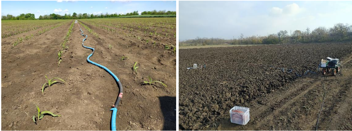
8. ábra: A dinamikus kamrás talaj CO 2 kibocsátás mérés Picarro G2508 analízátor segítségével a Martonvásári trágyázási tartamkísérletben (fotók: Dencső Márton)
