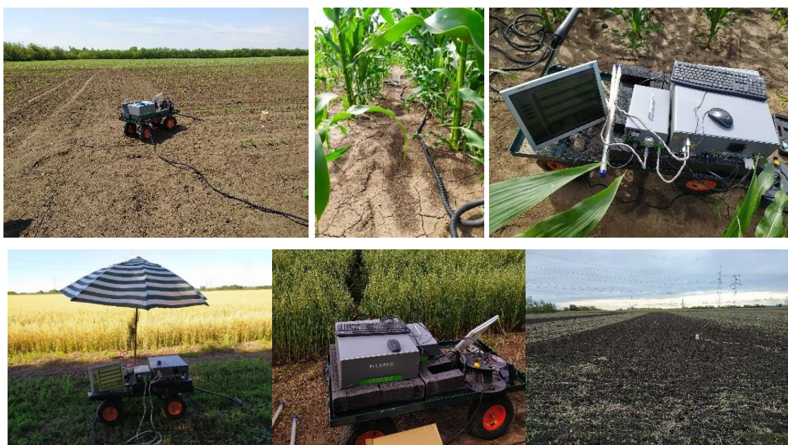
13. ábra: A talaj N 2 O kibocsátásának mérése Picarro analízator segítségével a Józsefmajori Kísérleti Tangazdaság talajművelési tartamkísérletében és a martonvásári trágyázási tartamkísérletben (fotók: Dencső Márton)
