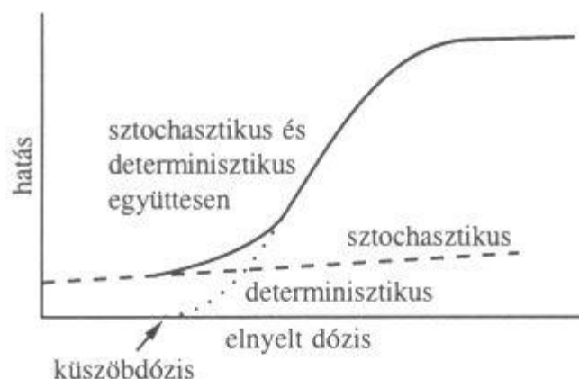
7. ábra A determinisztikus- és a sztochasztikus sugárhatás függése az elnyelt dózistól (forrás: Köteles György: Biológiai ismeretek és sugárvédelmi szabályozás (2004))
