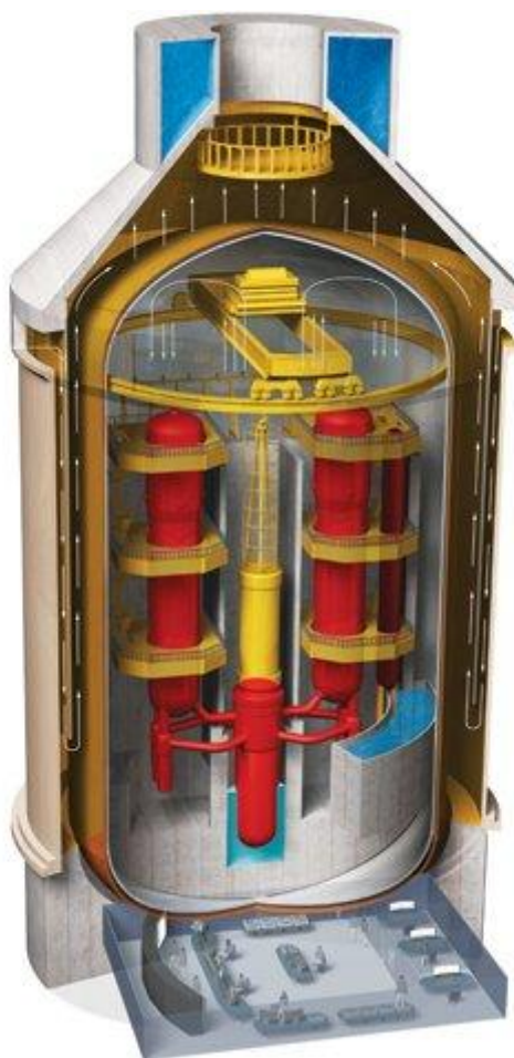
5. ábra. AP 1000-es típusú passzív konténment, külső energia nélkül képes elvezetni a maradék hőt a természetes cirkuláció segítségével [24].
