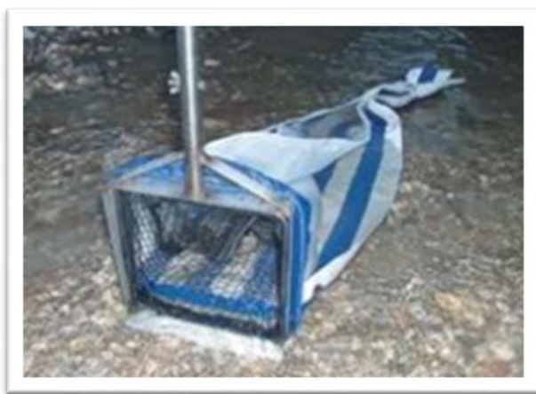
3. ábra. Az MHS mintavétel során alkalmazott kézháló (forrás: Graf és mtsai. 2015)
