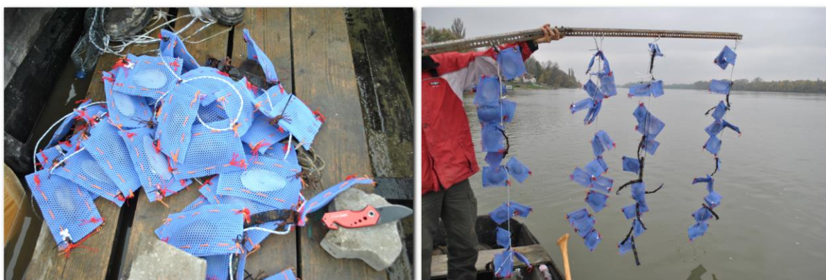
17. ábra. A kagylóhéjakat 10 mm-es sszembőségű hálóanyagból készült tasakokba (zsákokba) tettük. A mederfelszínen tartáshoz vasból készült rudat használtunk kezelésként, amire a 6 párhuzamos mintát rögzítettük (fotó: Bódis Erika)
